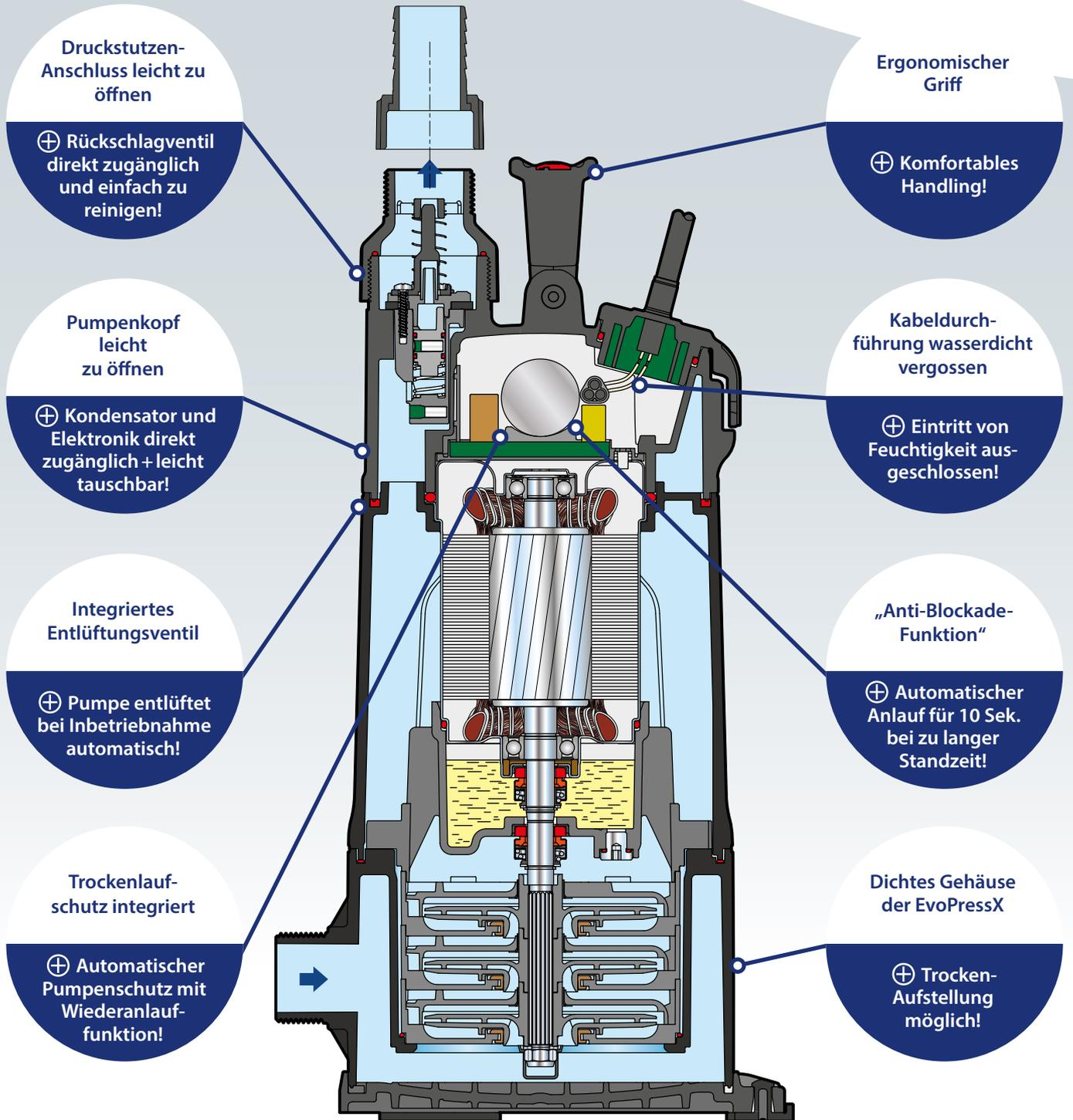
Druckstutzen-Anschluss leicht zu öffnen
